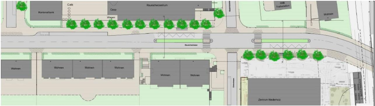
Die UVEK begrüsst diese Massnahme, welche die Sicherheit bei Strassenquerungen erhöht, das Überholen des in der Haltestelle stehenden Busses verhindert, die gefahrenen Geschwindigkeiten tendenziell reduziert und den Anteil der nicht versiegelten Fläche erhöht. Die UVEK schlägt aus denselben Gründen vor, eine dritte Mittelinsel zu realisieren. Der Bereich des Quartierzentrums vom neuen Zentrum Niederholz bis nach dem Rauracherzentrum, erhielte so eine einheitlichere Gestaltung (vgl. Abbildung 3).
