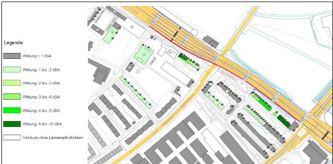
Abbildung 6: Effekte einer Erhöhung der Lärmschutzwand Schwarzwaldallee auf 7 Meter
